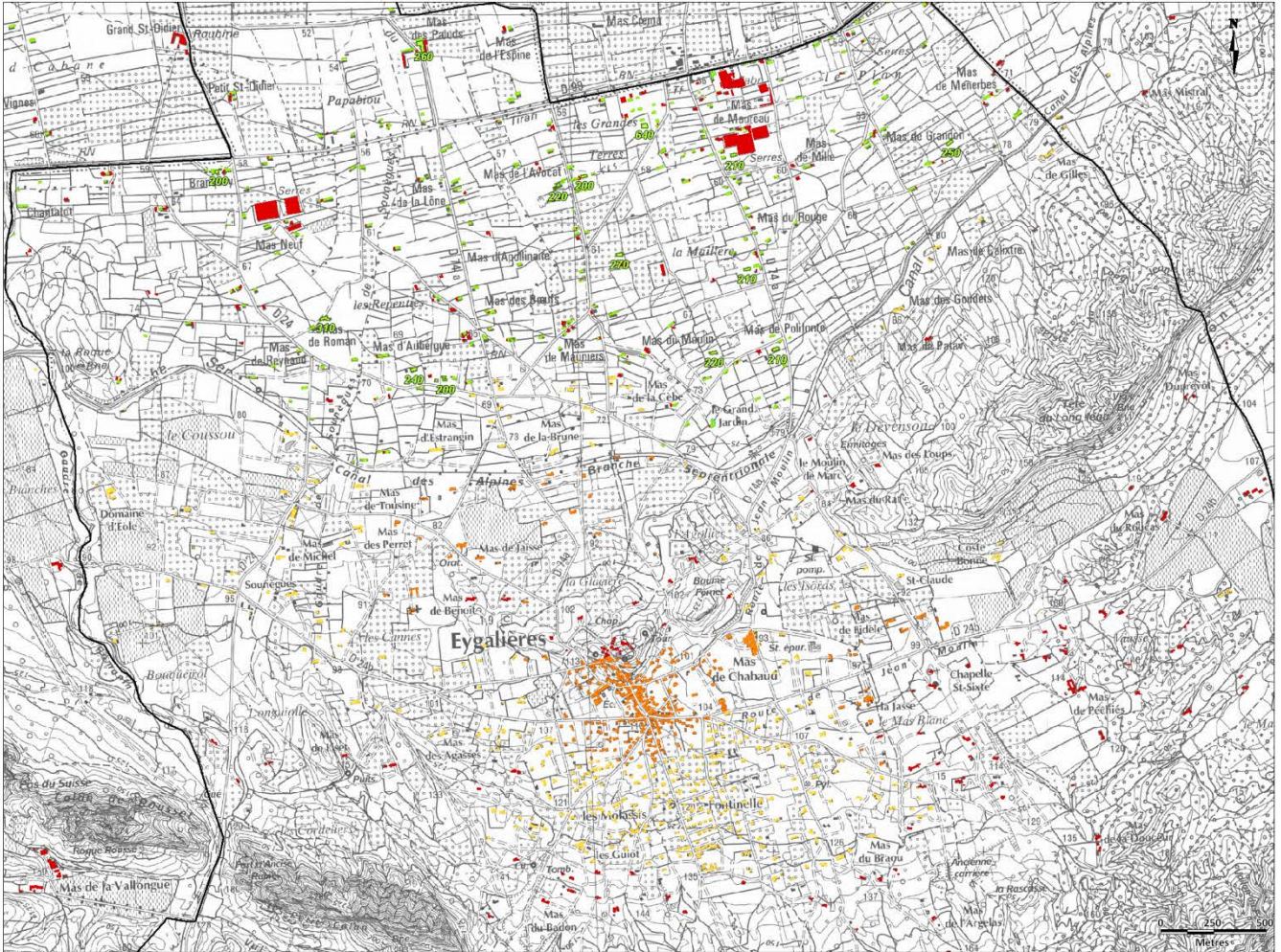
Toitures exploitables par des panneaux photovoltaïques
